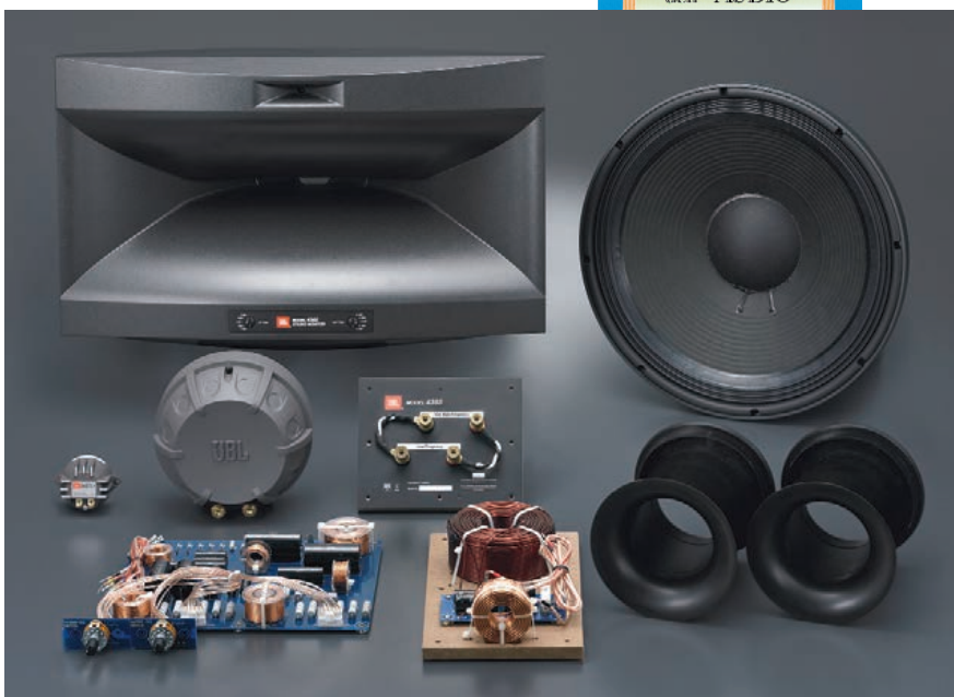
Foto di famiglia di tutti i componenti della 4365. Il driver per le note alte ha la cupola da 100 millimetri in lega di magnesio ed è caricato con una corta tromba in SonoGlass, un materiale denso ed afono. Nella parte superiore del tweeter è ricavata una piccola tromba per il driver delle note altissime, da 15 a 40 kHz. La prestazione è ottenuta grazie ad un driver a compressione dotato di una cupola da 25 millimetri in titanio.
