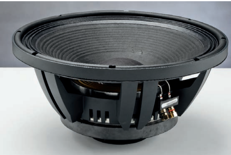
Il grosso trasduttore da quindici pollici è realizzato attorno ad un cestello in pressofusione di dimensioni notevoli. La membrana è irrigidita da rinforzi anulari concentrici, e la sospensione è realizzata in tela trattata a più corrugazioni. Notevole il complesso magnetico.
