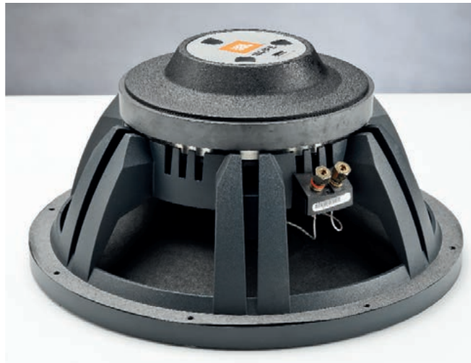
Il grosso trasduttore da quindici pollici è realizzato attorno ad un cestello in pressofusione di dimensioni notevoli. La membrana è irrigidita da rinforzi anulari concentrici, e la sospensione è realizzata in tela trattata a più corrugazioni. Notevole il complesso magnetico.
